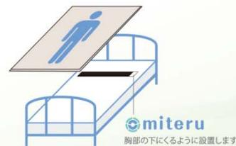
センサーは寝具の下に敷いて、電源コンセントに繋げるだけで測定が可能です。センサー本体は薄く、さらに非接触センサーなので睡眠の邪魔になりません。
